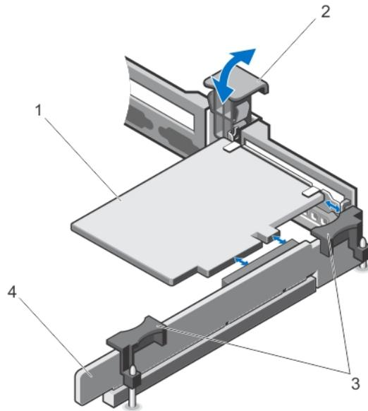
그림 19. 확장 카드 라이저 1 에서의 확장 카드 분리 및 설치
