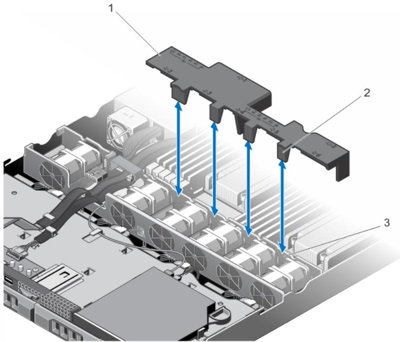
그림 10. 냉각 덮개 분리 및 설치
