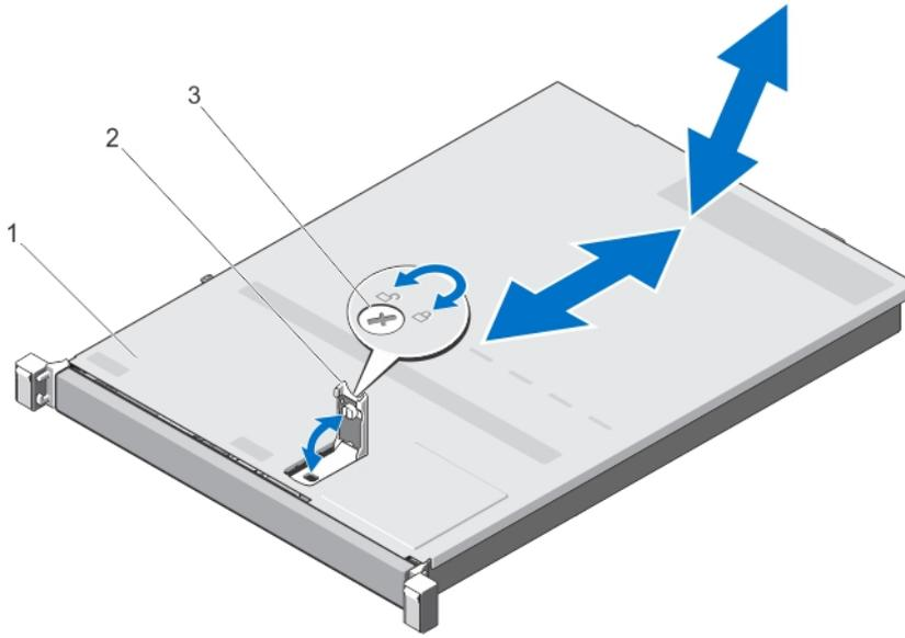
그림 8. 시스템 열기 및 닫기
