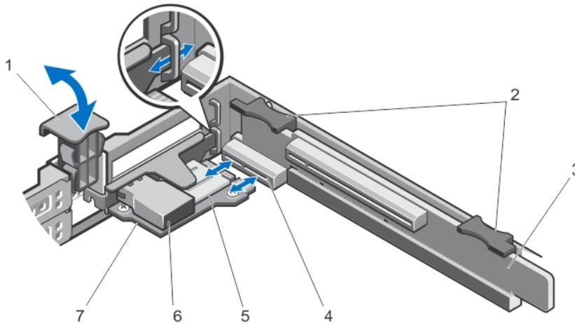
그림 23. iDRAC Ports 카드 분리 및 설치
