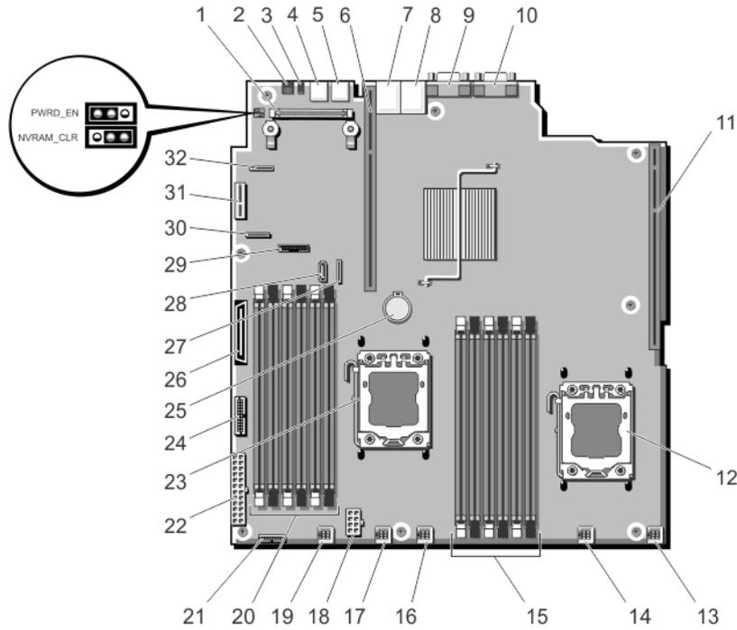
그림 40. 시스템 보드 점퍼 및 커넥터
