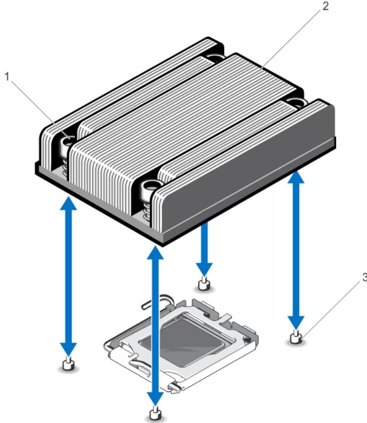
그림 27. 프로세서 방열판 분리 및 설치
