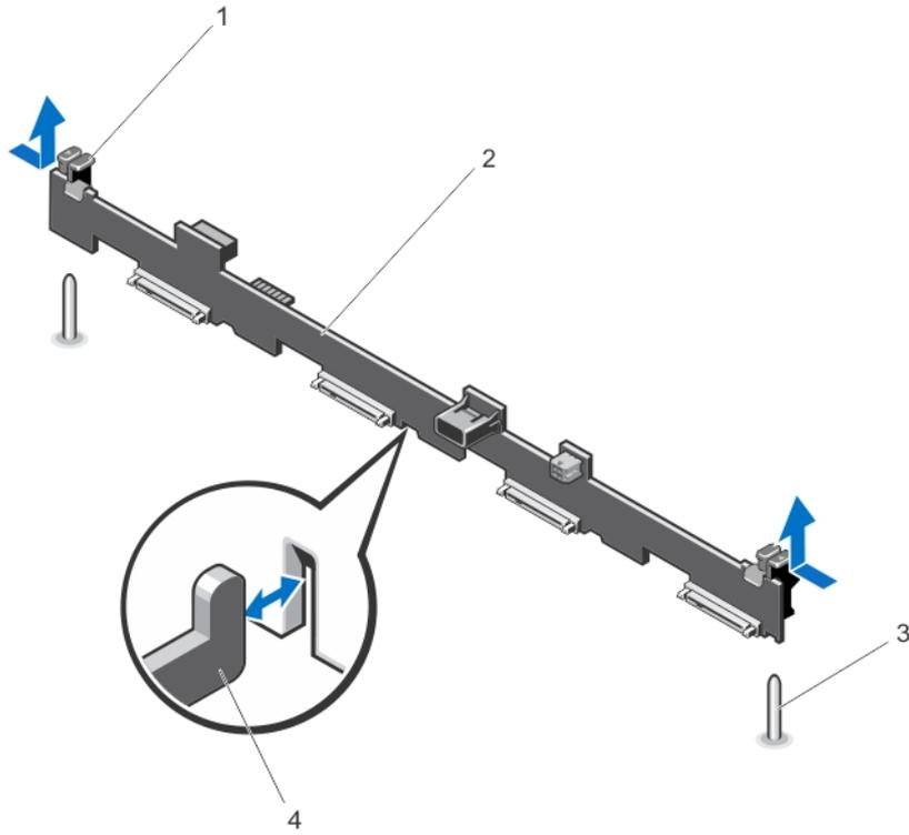
그림 33.4 개 하드 드라이브 후면판 분리 및 설치
