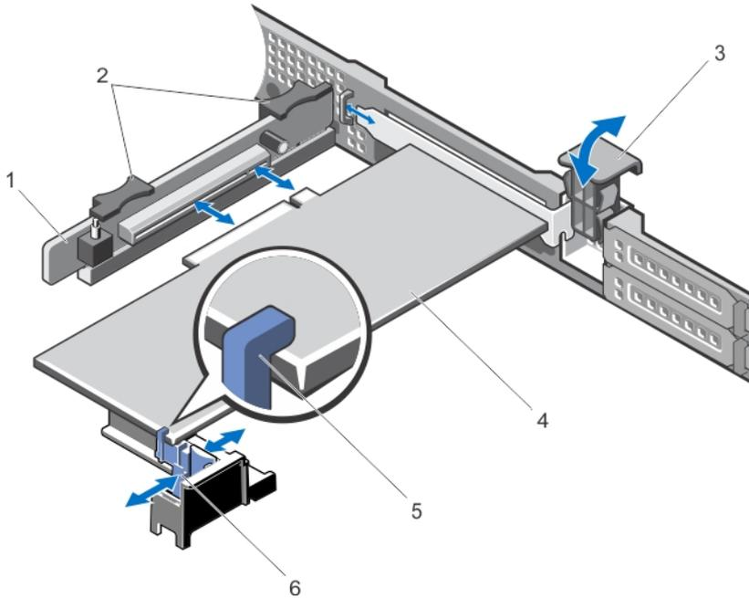
그림 20. 확장 카드 라이저 2에서의 확장 카드 분리 및 설치
