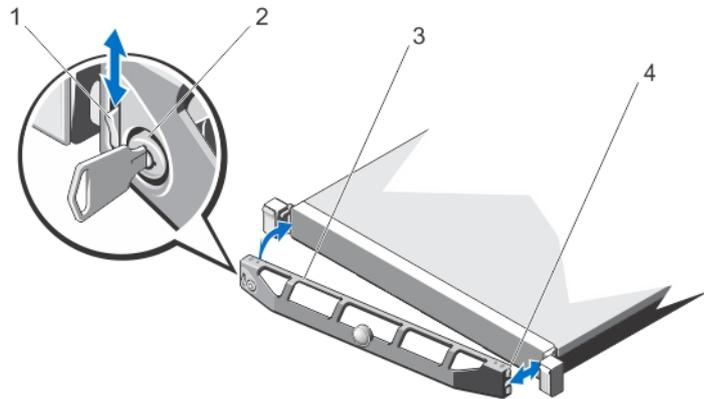
그림 7. 전면 베젤 설치 및 분리
