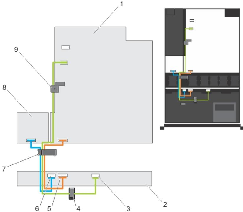
그림 34. 케이블 연결 다이어그램—4 개 하드 드라이브 후면판
