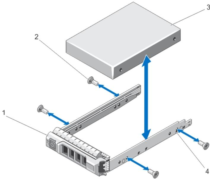
그림 15. 하드 드라이브 캐리어에서 핫스왑 하드 드라이브 분리 및 설치
