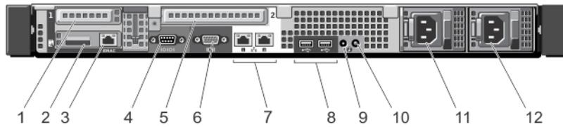
그림 4. 후면 패널 구조 및 표시등
