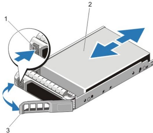
그림 14. 핫 스왑 하드 드라이브 분리 및 설치
