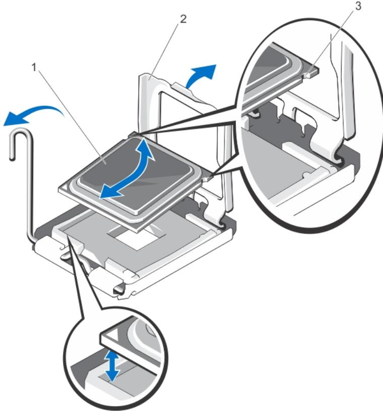
그림 28. 프로세서 분리 및 설치
