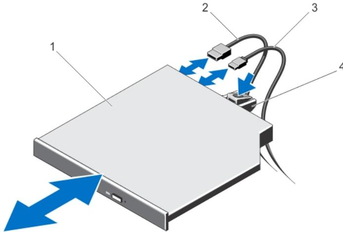
그림 16. 광학 드라이브 분리 및 설치
