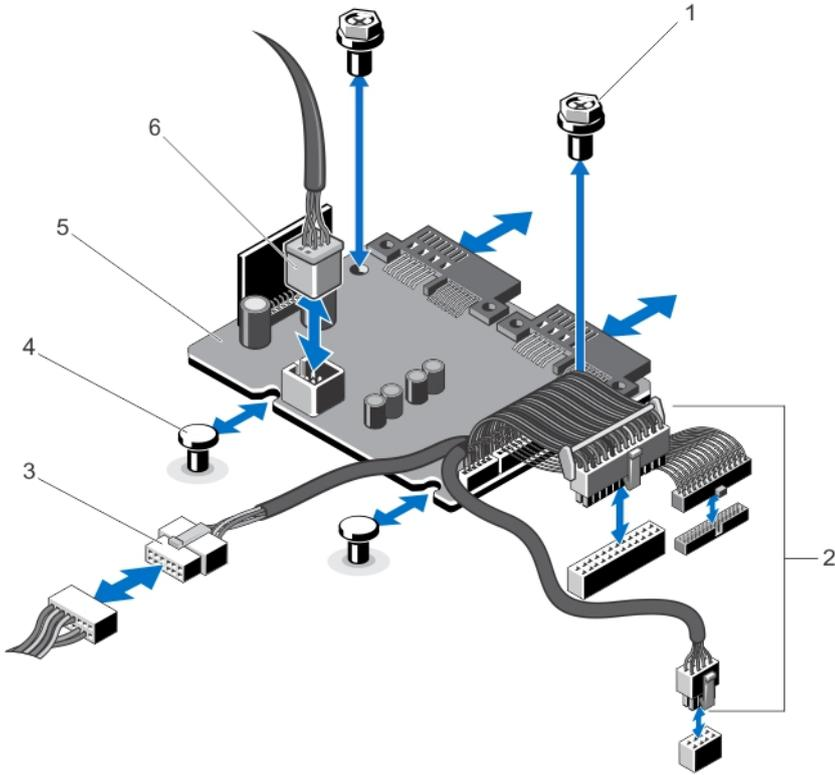
그림 38. 배전 보드 분리 및 설치
