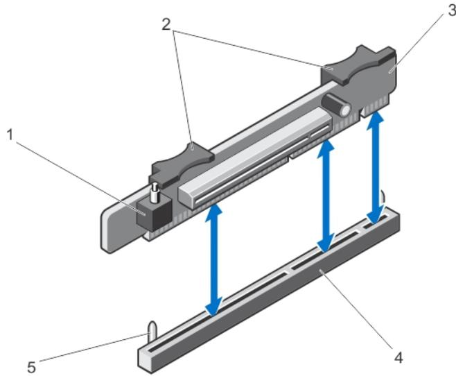
그림 22. 확장 카드 라이저 2 분리 및 설치
