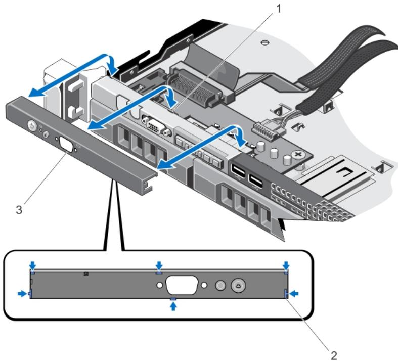
그림 35. 콘솔 분리 및 설치
