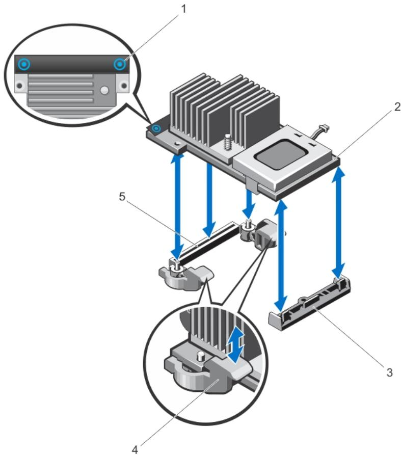
그림 26. 내장형 저장소 컨트롤러 카드 분리 및 설치
