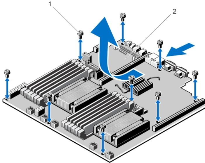
그림 39. 시스템 보드 분리 및 설치
