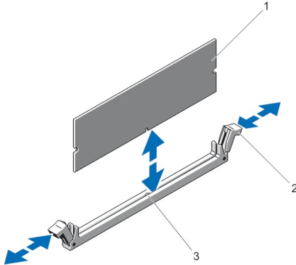
그림 12. 메모리 모듈 분리 및 설치
