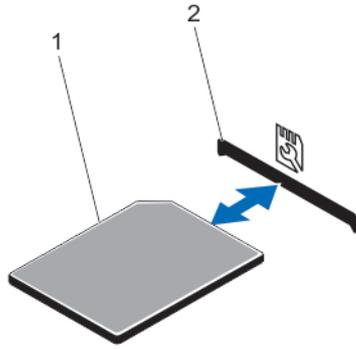
그림 24. SD vFlash 카드 분리 및 설치
