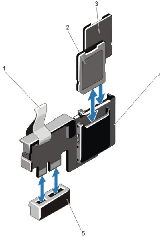
그림 25. 내부 이중 SD 모듈 분리 및 설치
