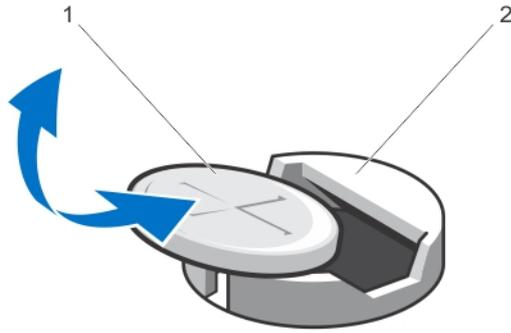
그림 30. 시스템 전지 장착
