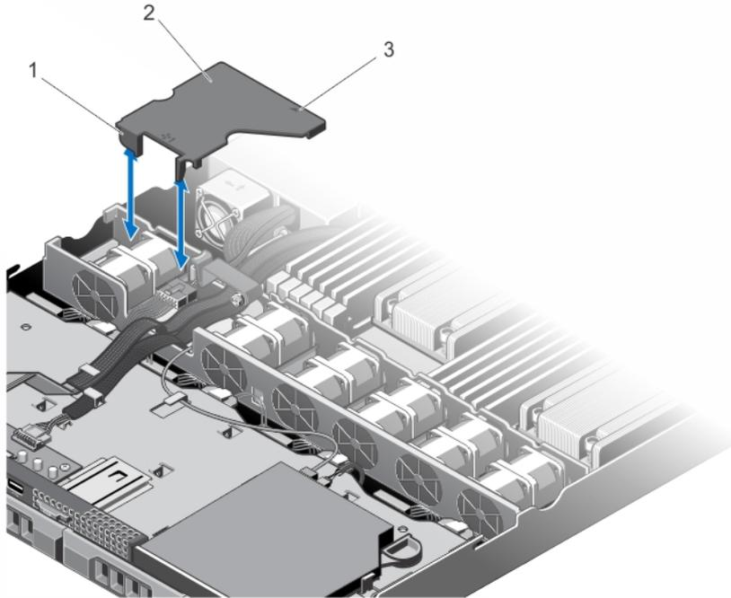
그림 37. PDB 덮개 분리 및 설치
