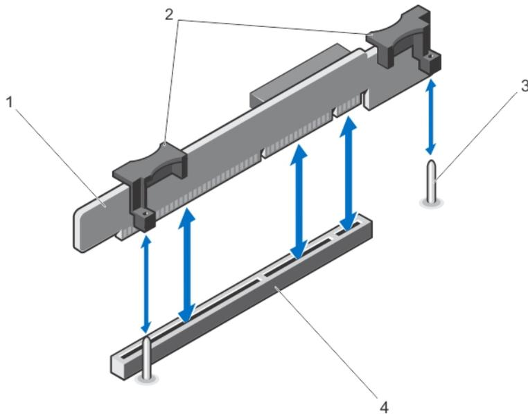
그림 21. 확장 카드 라이저 1 분리 및 설치
